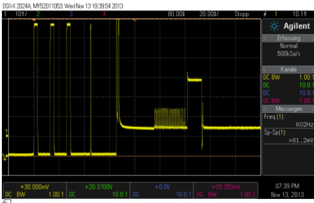
Einschaltstrom der Dimage 7Hi, x-Achse: 20ms/DIV, Y-Achse: 200mA/DIV
