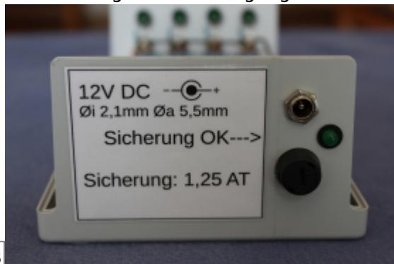
Beschriftung der Spannungsversorgung
